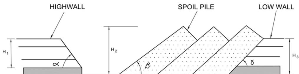
HIGHWALL - ANGLE ( $\alpha$ ) & HEIGHT ( $H_1$ )
